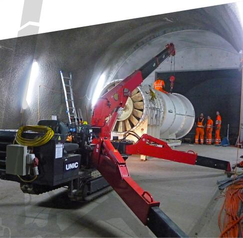
Der **UNIC 506** bietet die optimale Kombination von Arbeitsflexibilität und hoher Traglaststärke. Wie üblich kann auch dieser Kran vom Fahrstuhl oder per Funkfernsteuerung bedient werden.
