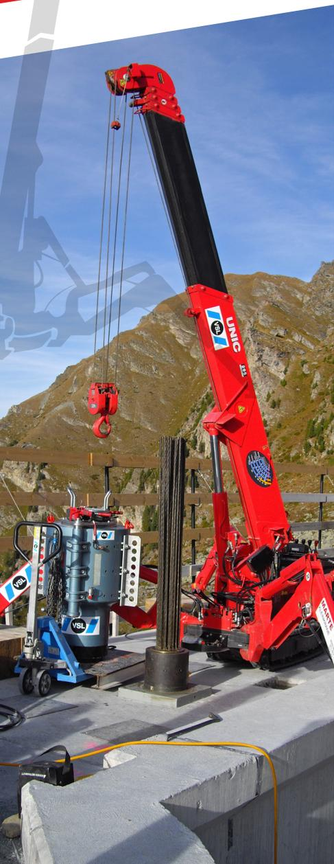
Der **UNIC 295** ist der erste Minikran Europas, der schmal genug ist, um durch einen Standardtür-rahmen zu fahren, aber eine Tragkraft von fast 3 Tonnen aufweist. Er ist zudem technisch führend bei den Sicherheitseigenschaften. Der Kran wird von einem Benzin-, Gas- oder Elektromotor angetrieben. Er eignet sich ideal für Arbeiten in Innenräumen oder andere beengte Platzverhältnisse.
